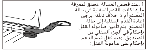
3. لتأكد من وضع الغسالة في الحالة الصحيحة ،قم بفك صامولة القفل في الاتجاه الموضح في المخطط بمفتاح الربط المرفق إلى بالارتفاع المناسب حتى تصبح قدم الدعم قريبة من الأرض ولا تهتز الغسالة.
