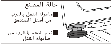
2. بمجرد وضع الغسالة ،اضغط على الزاوية المقابلة للغطاء العلوي للغسالة بيدك كليهما وقم بهزها رأسيا إلى أسفل للتحقق مما إذا كانت قدم الدعم قريبة من الأرض وما إذا كانت الغسالة تهتز
