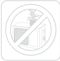
تأكد من عدم انسداد أي مداخل أو مخرج للهواء
